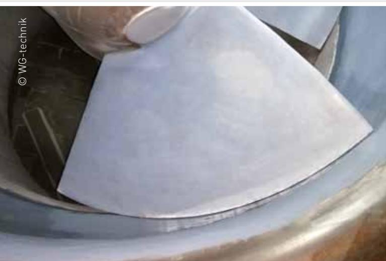
Zum Schutz vor erneutem Verschleiß wurden der Laufradmantel und die Laufschaufeln mit einer Belzona-Keramikbeschichtung überzogen.
